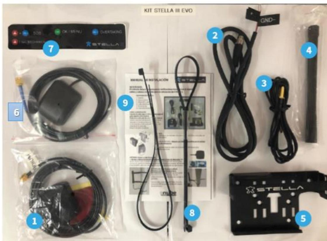
1 - Antena Iridium / 2 - Cabo de alimentação / 3 - Cabo RF / 4 - Antena RF / 5 - Base/Montante
